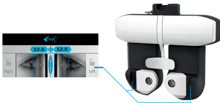
Figura 3: Misurazione della distanza occhio-rifratore mediante videocamera
