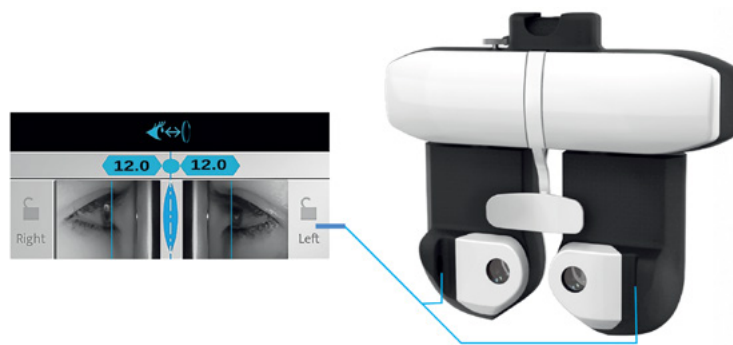
Figure 3 : Mesure de la distance œil-réfracteur par caméras vidéo
