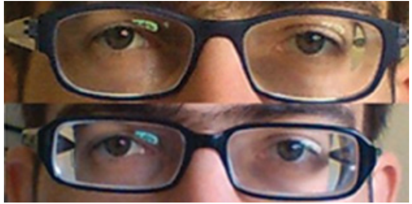
FIG. 9 | Calcul du grossissement induit par un verre: effet de rapetissement des image dans le cas d'un verre corrigeant un myope.
