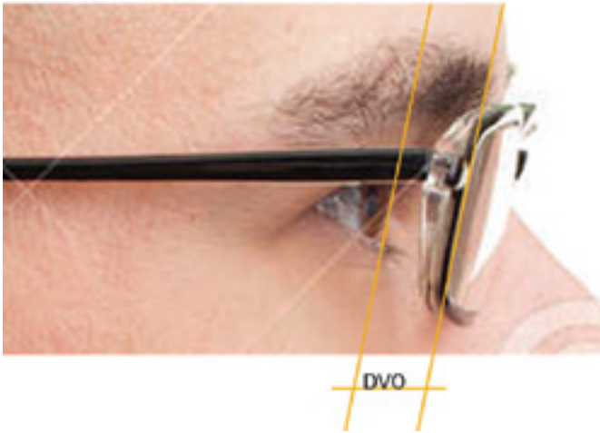
FIG. 6] Variation de la correction du myope avec la distance verre-œil (DVO). Le déplacement du verre de L0 en L1 provoque une défocalisation. La distance focale du verre correcteur devient f^*L1 > f^*L0 . Pour compenser une myopie, la puissance doit diminuer si le verre est plus proche de l'œil.
