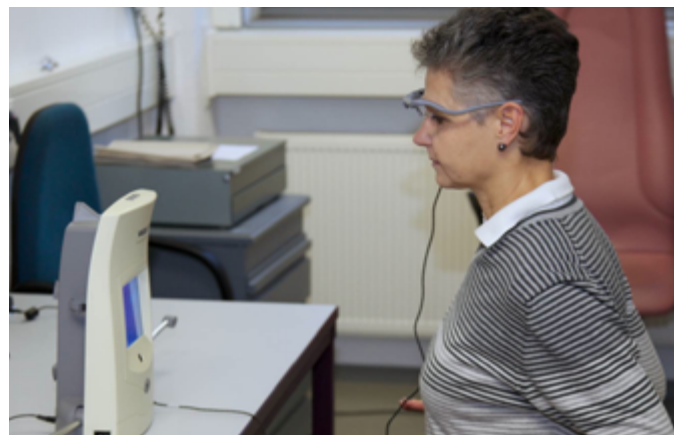
ABB. 2 | Bestimmung der Kopfdrehung und Erfassung des HEQ mit Hilfe des Vision Print® Systems von Essilor. Der Proband sitzt aufrecht ca. 40 cm von der Vorrichtung entfernt und hält in den Ellbogen eine Stange, damit der Oberkörper nicht zur Seite kippt. Der Proband folgt den LEDs, die nacheinander erscheinen.
