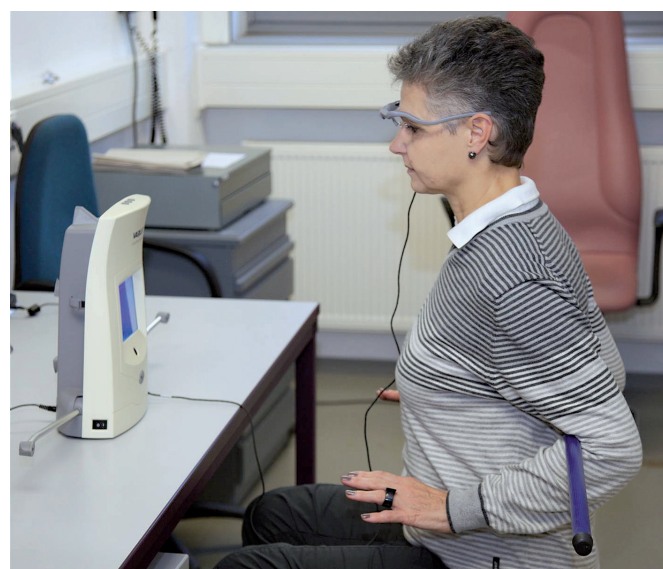
FIG. 2 | Détermination des mouvements de la tête et calcul du rapport tête/yeux avec l'appareil Vision Print® System d'Essilor. Le sujet est assis et se tient droit à environ 40 cm de l'appareil, il passe ses bras derrière une barre pour empêcher le tronc de se pencher sur le côté. Le sujet suit du regard les LEDs périphériques qui clignotent.
